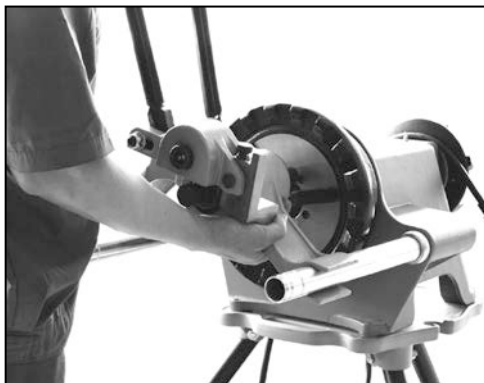
Рис 1 Установка желобонакатчика на силовой привод.
